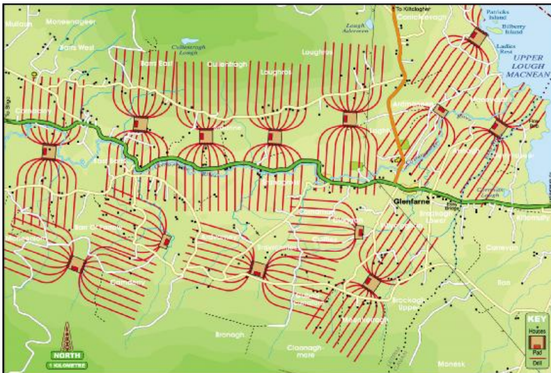
14 pav. Skalūnų dujų telkinio horizontalių gręžinių išdėstymo schema, JAV [http://brigittavaradi.squarespace.com/talk-about-fracking]
